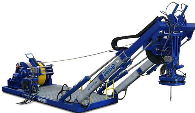
Полностью интегрированная система, спроектированная и созданная для спуска и подъема ROV, состоит из механизма лебедки/тросоукладчика, самоподнимающейся П-рамы, шкива и электрогидравлического блока питания, закрепленных на единой платформе. Инновационный дизайн позволяет с легкостью перевозить всю систему в контейнере ISO. Во время транспортировки ROV находится на платформе для дальнейшего упрощения оперативной мобилизации.
