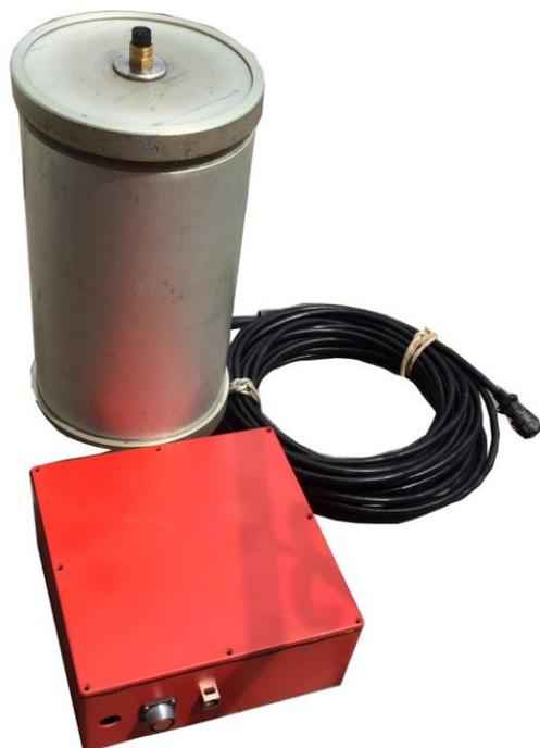
**Назначение:** Контроля подводной радиационной обстановки
